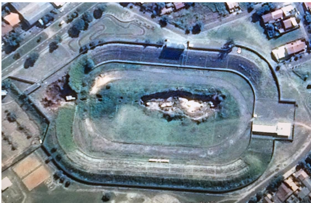
Figura 3 – Processo Erosivo no Centro Poliesportivo na cidade de Umuarama-PR.
